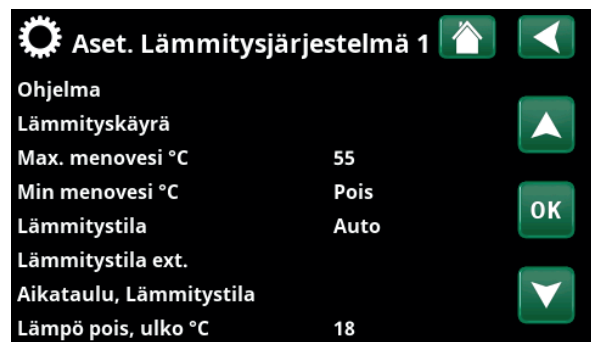
Osa valikkoa "Edistyneempi/Asetukset/Lämmitysjärjestelmä/LJ1".
