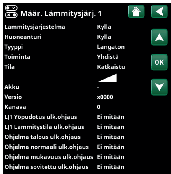
Valikko "Edistyneempi/Määrittele/Lämmitysjärjestelmä/LJ1". Langaton huoneanturi on valittu.
