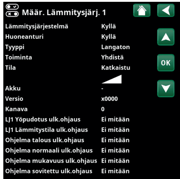
Valikko "Edistyneempi/Määrittele/Lämmitysjärjestelmä/LJ1". Langaton huoneanturi on valittu.
