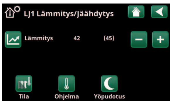
Valikko "Edistysellinen/Määrittele/Lämmitysjärjestelmä/Lj1". Lämmitysjärjestelmässä ei ole huoneantureita. Asetuspiste (menoveden lämpötila 45 °C) näkyy suluissa, nykyinen menoveden lämpötila 42 °C näkyy asetuspisteen vasemmalla puolella.
