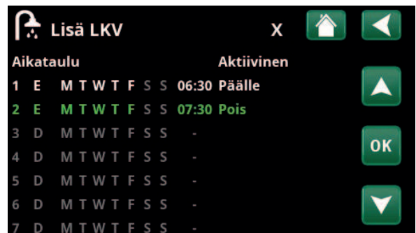
"Lisä LKV"-toiminto on asetettu aktiiviseksi arkipäivisin klo 6.30 ja 7.30. Napsauta LKV-kuvaketta alla olevan esikatselun näyttämiseksi.
