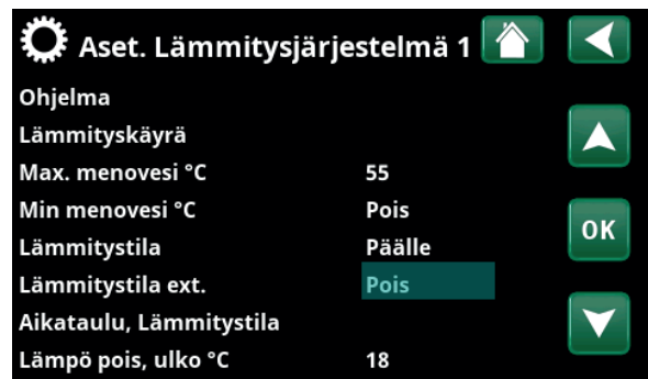
Valikko "Edistyneempi/Asetukset/Lämmitysjärjestelmä/LJ1". Kauko-ohjaustila "Pois" aktivoituu, kun liitin K24 suljetaan.
