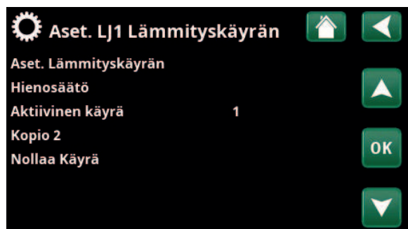
Valikko "Edistyneempi/Asetukset/Lämmitysjärjestelmä/LJ1/Lämmityskäyrä".
