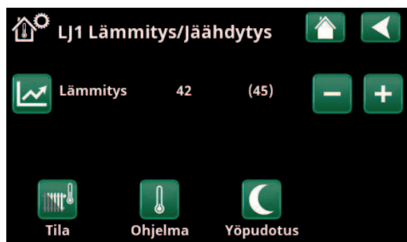
Valikko "Edistyneellinen/Määrittele/Lämmitysjärjestelmä/LJ1". Lämmitysjärjestelmässä ei ole huoneantureita. Asetuspiste (menoveden lämpötila 45\text{ }^{\circ}\text{C} ) näkyy suluissa, nykyinen menoveden lämpötila 42\text{ }^{\circ}\text{C} näkyy asetuspisteen vasemmalla puolella.
