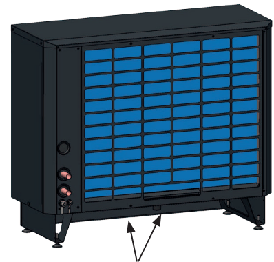
Kondenssivesialtaat ja kondenssivesiputket.
